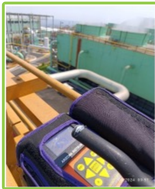
Monitoreo ambiental de calidad del aire y ruido en centrales geotérmicas de Berlín y Ahuachapán en operación
