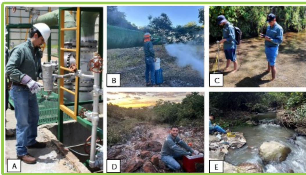
Figura 4. Monitoreos rutinarios de: A) Agua y vapor en pozos productores; B) Línea de reinyección; C) Medición de caudales; D) Monitoreo de Fumarolas; E) Monitoreos ambientales.
