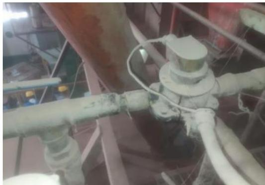
Ilustración 1 Medidor de flujo de melaza de disco nutante.
